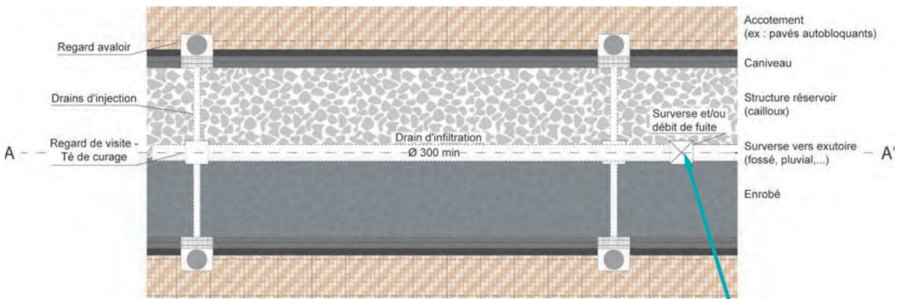
Image 2 : Vue de dessus d'une structure réservoir en secteur « Sable des Landes ».
